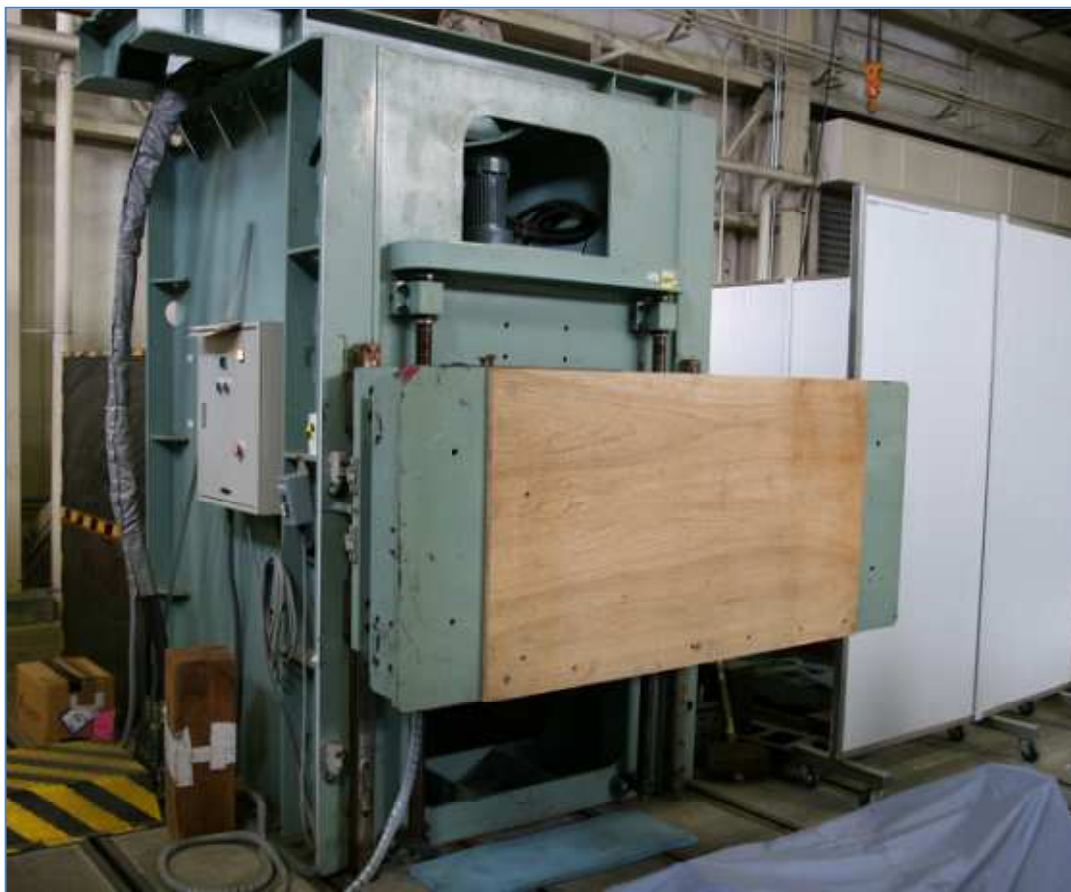
台上圧縮試験装置(Component Compression Test Facility)
