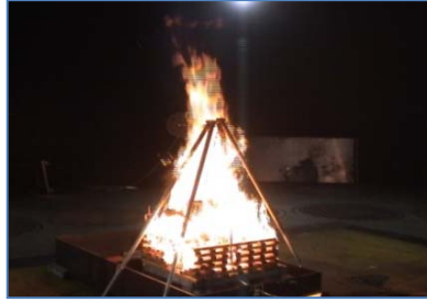
木材ク립による火災暴露試験
