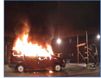
熱流束計を使用した 火災試験による火傷評価
