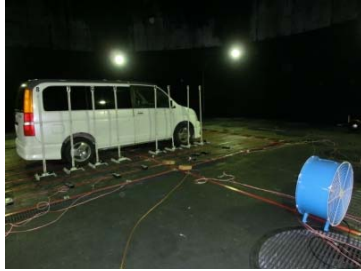
水素漏洩車両への送風影響
